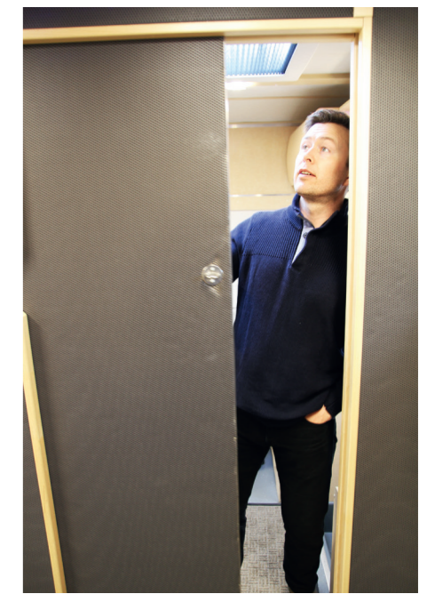
En lydtett vegg deler arbeidsrommene bak i bilen i to.
